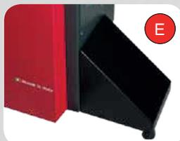
**PIE DE ESTABILIZACIÓN (OPCIONAL):** El juego de fijación al suelo, provisto de serie, permite operar sobre ruedas de peso máximo 75 Kg (165 lbs). Para evitar fijar la equilibradora al suelo, está disponible como opcional el pie de estabilización KIT P para una capacidad máxima rueda de 50 Kg (110 lbs).
