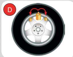
**PROGRAMA PESO ESCONDIDO Y PLANOS MÓVILES (ALU P):** «Peso Escondido» divide el peso adhesivo externo en 2 partes a posicionar detrás de los rayos de la llanta. El programa «Planos Móviles» calcula la posición de equilibrado para utilizar pesos adhesivos múltiples de 5 gr.
