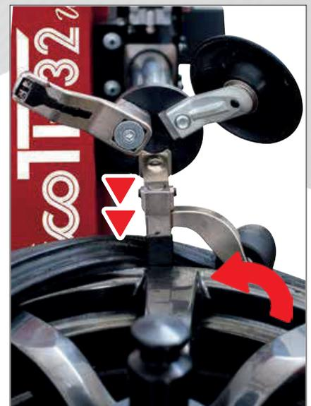
**Proceso de MONTAJE** completo más fácil gracias a la herramienta y al prensador incorporado siempre en la misma posición.
