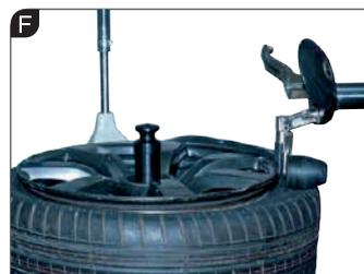
**E-F**. Al poner la herramienta de montaje del **REVÓLVER** entre la llanta y el neumático, el **RODILLO DE PLÁSTICO** del **REVÓLVER** ayudará automáticamente a que el neumático permanezca en el canal. Gracias a la rotación del autocentrante de fijación axial y la ayuda del prensa talón de rotación de serie, el **montaje final será muy sencillo**.
