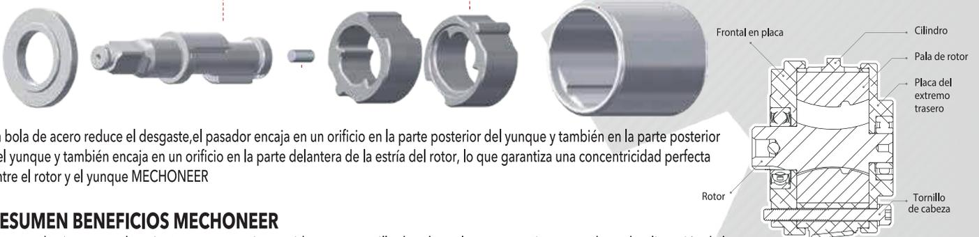
La bola de acero reduce el desgaste, el pasador encaja en un orificio en la parte posterior del yunque y también en la parte posterior del yunque y también encaja en un orificio en la parte delantera de la estría del rotor, lo que garantiza una concetricidad perfecta entre el rotor y el yunque MECHONEER
