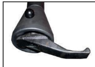
La cabeza de la herramienta de desmontaje se incorpora con el rodillo de presión de los neumáticos. Es posible extraer el cabezal de peaje y sólo utilizar el rodillo de presión de neumáticos para ahorrar espacio de operación.
