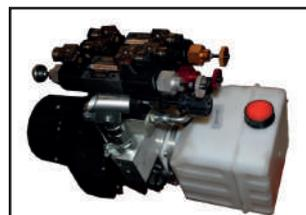
Equipada con bomba manual de emergencia que asegura el retroceso de la desmontadora al vehículo en caso de pérdida de energía eléctrica.
