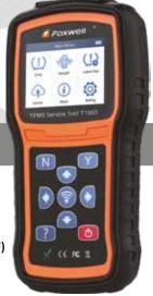
Decodificador o activador de sensor TPMS universal Se activa con precisión y decodifica TPMS sensores y muestra los datos o cualquier fallo
